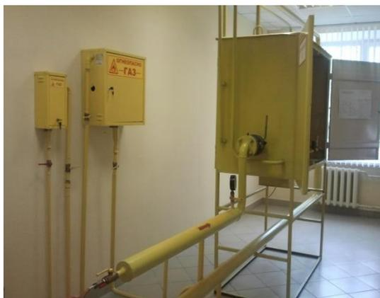
Для отработки работниками навыков по обслуживанию пунктов редуцирования газа имеется учебно-тренировочный стенд, включающий в себя ГРПШ -04-2У1, ГРПШ-6 и ГРПШ-10, работающие на сжатом воздухе.
