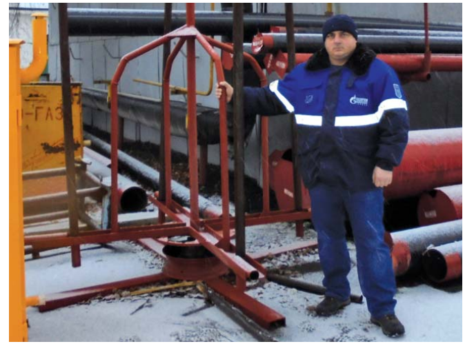
«ПРИСПОСОБЛЕНИЕ «КАРУСЕЛЬ» ДЛЯ РАЗМOTКИ БУХТОВЫХ ТРУБ ПЭ – Ø 63, ПЭ – Ø 110»
